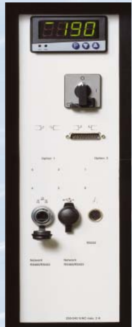
Hauptschalter, Prüfgutschutz und Schnittstellen
