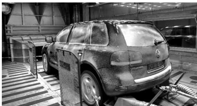
Volkswagen Wolfsburg, Kälte- und Klimazentrum auf 5.400 Quadratmetern Investitionskosten 30 Millionen Euro Im Bild: Tieftemperaturtest in der Klima-/Kältekammer 2 mit Allrad-Rollenbetrieb, Fahrtwind- und Sonnenlichtsimulation VW Wolfsburg, 5,400 square meter cold/climate testcenter. The picture shows a low temperature testing facility
