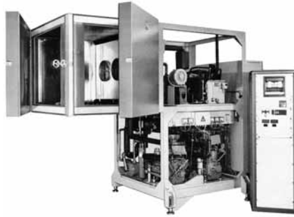
Weiss-Vibrationsprüfschrank 1989 - geringe Höhenanpassung möglich Weiss vibration test chamber 1989 - slight height adjustment possible
