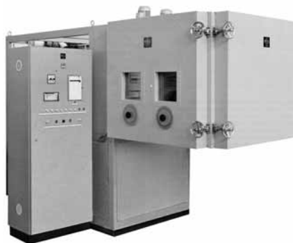
Weiss- Vibrationsprüfschrank 1985 Starres Gestell für bestimmte Shakertypen Weiss vibration test chamber 1985 rigid frame for certain types of shakers
