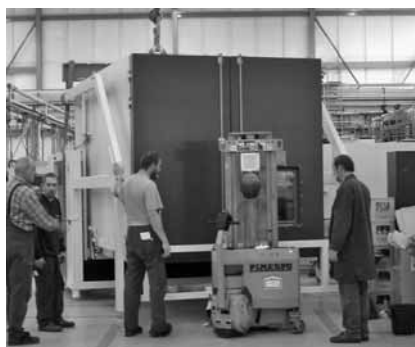
Vibrations-Prüfschrank mit Prüfraumvolumen von acht Kubikmetern Vibration test chamber with a chamber volume of eight cubic meters
